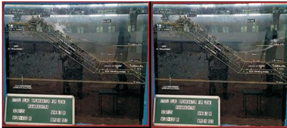
फोटो 2 : 4 t स्टील स्लैंग टेट्रापॉड से ब्रेकवाटर की कवच परत पर तरंग क्रिया -4.0 मीटर बेड लेवल पर अधिकतम ब्रेकिंग वेव ऊंचाई (Hb) 6.50 मीटर के डिज़ाइन जल स्तर के दौरान +4.80 मीटर।
