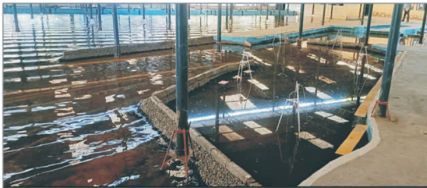
चित्र 4: भौतिक तरंग प्रतिमान की तस्वीर, तरंग ऊंचाई/दिशा 2.5 मीटर/ 145° (SE) के स्थिति लिए। (चेन्नई बंदरगाह का उन्नत बैथिमीट्री भौतिक प्रतिमान)
